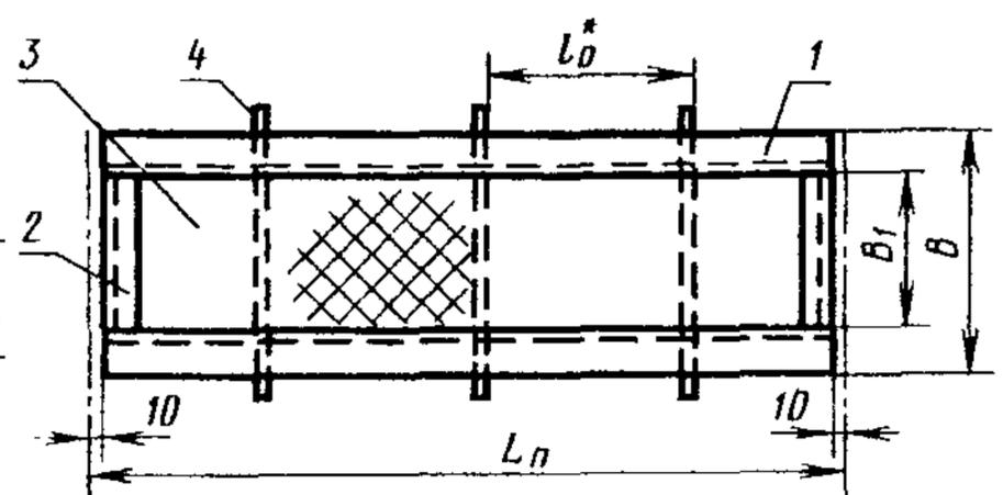
1—балка; 2—окантовочный элемент; 3—настил; 4—ребро
