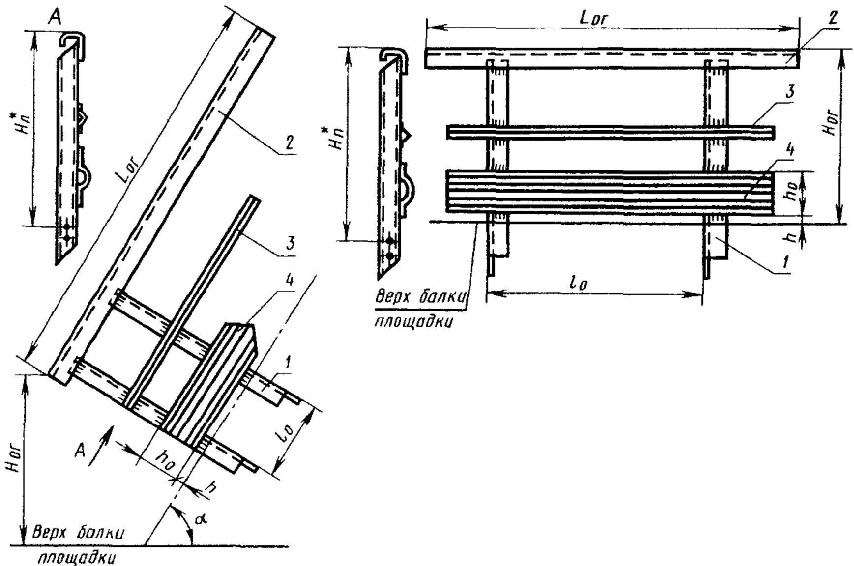
1—стойка; 2—поручень; 3—средний ограждающий элемент; 4—бортовой элемент
